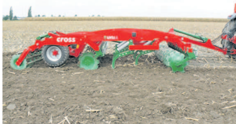
Jeden z aparatów służących do uprawy bezorkowej
