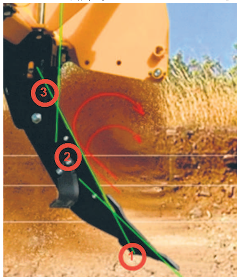
Zasada działania pługu zębowego
