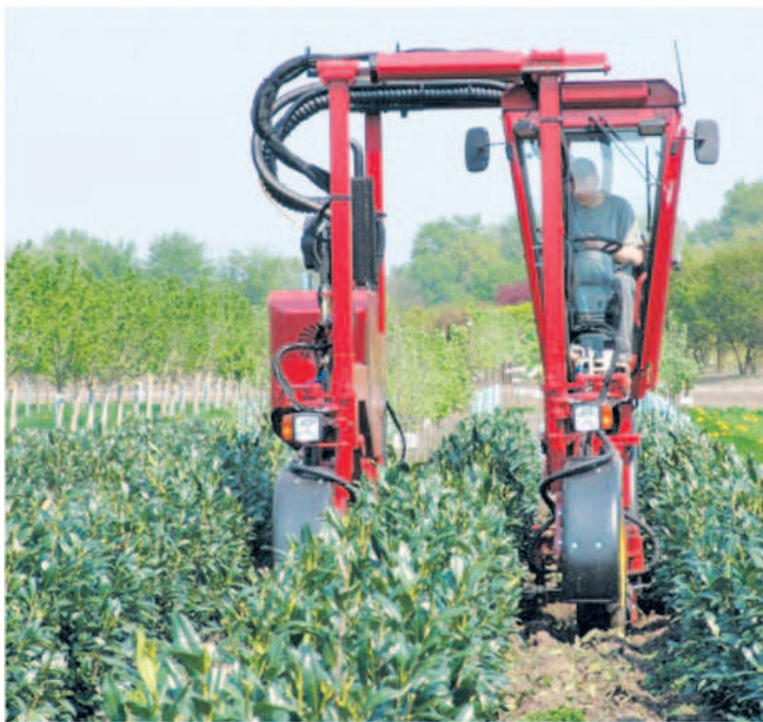
Traktor szczudłowy – narzędzie do walki ze stonką
